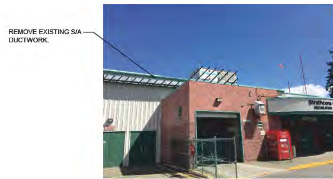
4 EXISTING DH-2 - DEMO M4 SCALE: NTS
